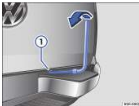
Fig. 202 Subir la rueda de repuesto mediante el cabrestante.
