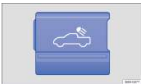
Fig. 76 En la consola central: tecla de la luz de la superficie de carga.
