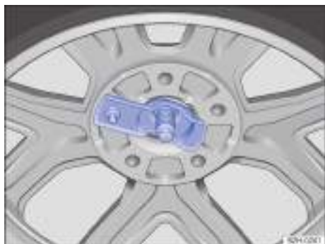
Fig. 200 Rueda de repuesto o de emergencia: colocación correcta del soporte para llantas en el orificio de la llanta.
