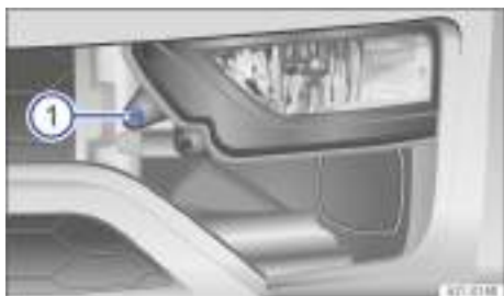
Fig. 148 En el paragolpes delantero: desmontar el faro.
