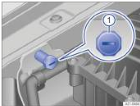
Fig. 163 En el lado derecho del vano motor: toma para la ayuda de arranque (terminal de masa).
