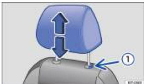
Fig. 67 En el asiento delantero: ajustar el apoyacabezas (variante 2).
