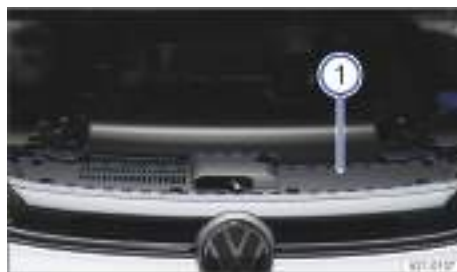
Fig. 176 Ubicación del adhesivo con la norma y la viscosidad del aceite del motor (representación esquemática).
