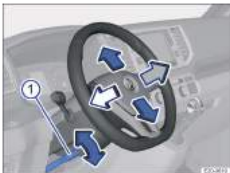
Fig. 54 Debajo del volante, en el guarnecido de la columna de dirección: palanca para el ajuste manual de la posición del volante.
