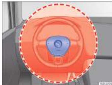
Fig. 29 Ubicación y zona de despliegue del airbag frontal del conductor.
