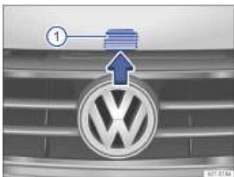
Fig. 171 Encima de la parrilla del radiador: palanca de accionamiento del capó delantero.
