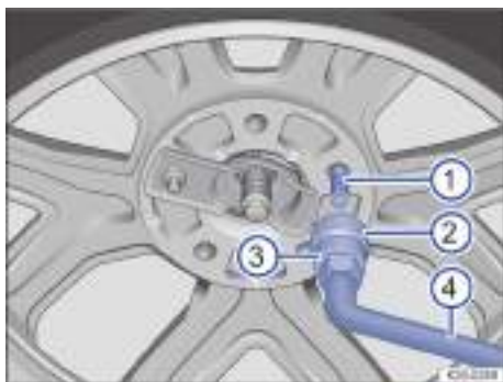
Fig. 203 Colocar la protección antirrobo.
