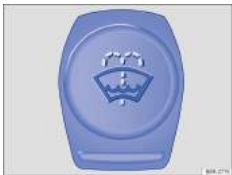
Fig. 174 En el vano motor: tapa del depósito del líquido limpiaparabrisas.
