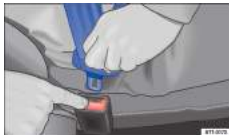
Fig. 20 Soltar la lengüeta del cierre del cinturón.
