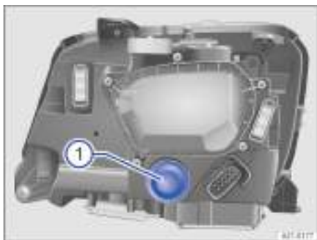
Fig. 145 En el vano motor: tapa en el faro de xenón.
