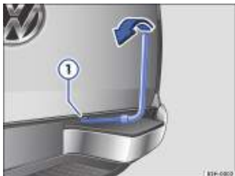
Fig. 196 Controlar el cable elevador con el cabrestante.
