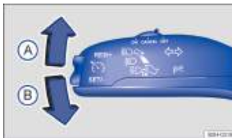
Fig. 73 En el lado izquierdo de la columna de dirección: palanca de los intermitentes y de la luz de carretera.
