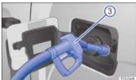
Fig. 137 Repostar AdBlue con la pistola de un surtidor.
