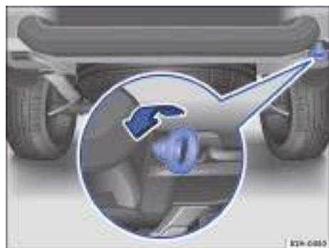
Fig. 166 En el lado derecho del paragolpes trasero: argolla de remolque enroscada.
