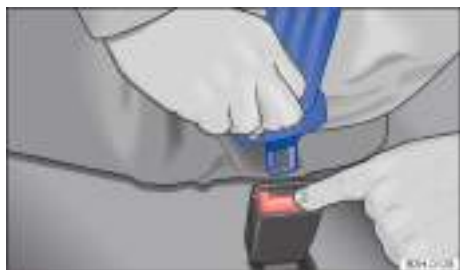
Fig. 24 Soltar la lengüeta del cierre del cinturón.
