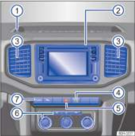
Fig. 8 Cuadro general de la parte superior de la consola central.
