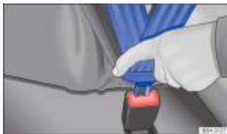
Fig. 23 Insertar la lengüeta del cinturón de seguridad en su cierre.
