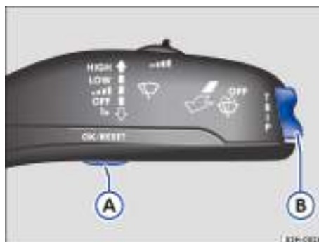
Fig. 13 En la palanca del limpiacristales: teclas para manejar los menús.
