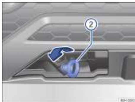
Fig. 169 En el lado derecho del paragolpes delantero: enroskar la argolla de remolque.
