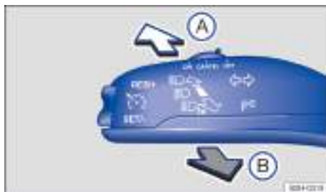
Fig. 72 En el lado izquierdo de la columna de dirección: palanca de los intermitentes y de la luz de carretera.
