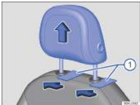
Fig. 66 En el asiento delantero: ajustar el apoyacabezas (variante 1).
