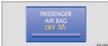
Fig. 28 En la parte superior de la consola central: testigo de control de la desactivación del airbag frontal del acompañante.
