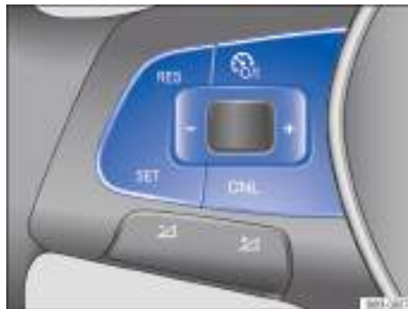
Fig. 106 Lado izquierdo del volante multifunción.
