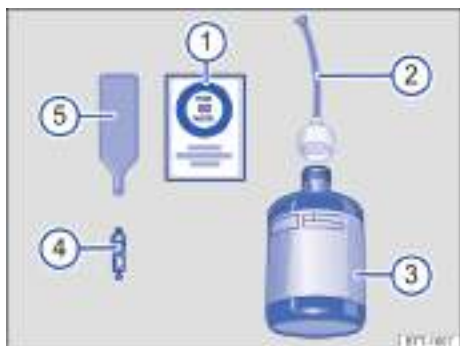
Fig. 211 Representación esquemática: componentes del kit reparapinchazos.
