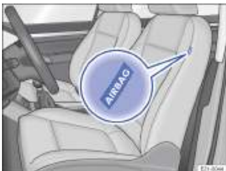
Fig. 34 Lateral de un asiento delantero: ubicación del airbag lateral para la cabeza y el tórax (variante 2).
