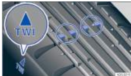
Fig. 189 Perfil del neumático: indicadores de desgaste.
