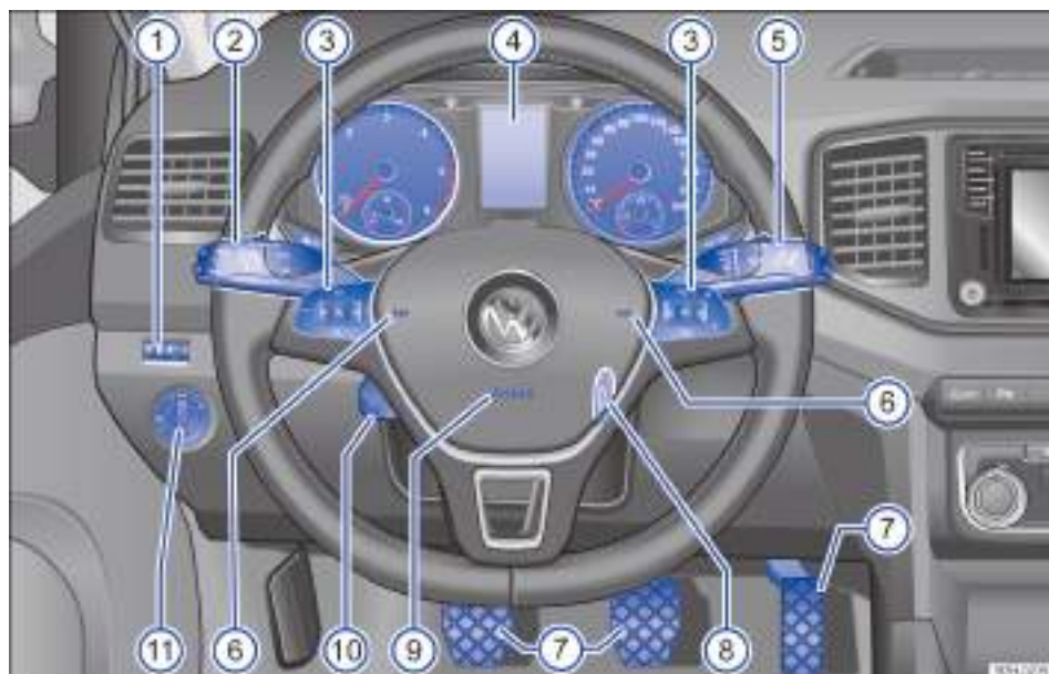
Fig. 6 Cuadro general del lado del conductor (vehículos con el volante a la izquierda).
