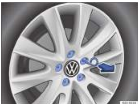
Fig. 192 Retirar las caperezas de los tornillos de rueda.
