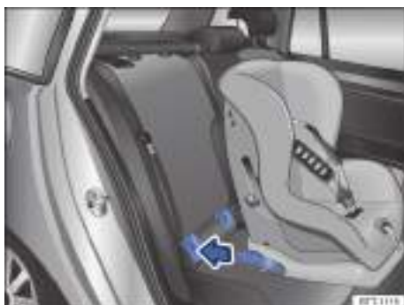
Fig. 41 Representación esquemática: montar el asiento para niños ISO-FIX con conectores.
