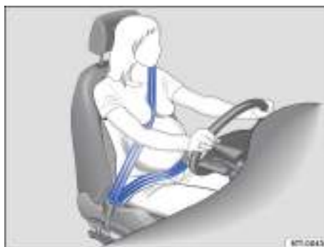
Fig. 26 Colocación correcta de la banda del cinturón en las mujeres embarazadas.
