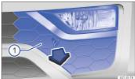
Fig. 147 En el paragolpes delantero: desmontar la cubierta.
