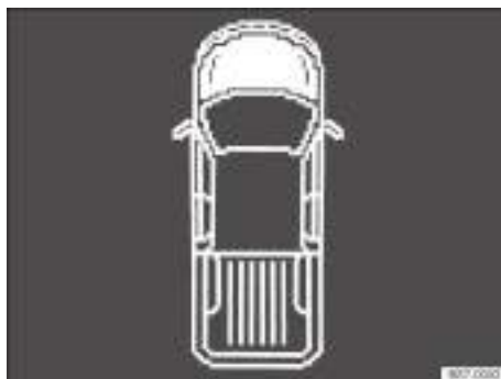
Fig. 173 En la pantalla del panel de instrumentos: capó delantero abierto o mal cerrado (representación esquemática).
