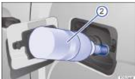
Fig. 136 Cargar AdBlue con una botella de recarga.
