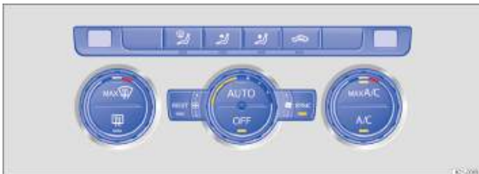
Fig. 86 En el tablero de instrumentos: mandos del Climatronic.
