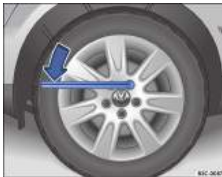
Fig. 193 Cambiar una rueda: aflojar los tornillos.
