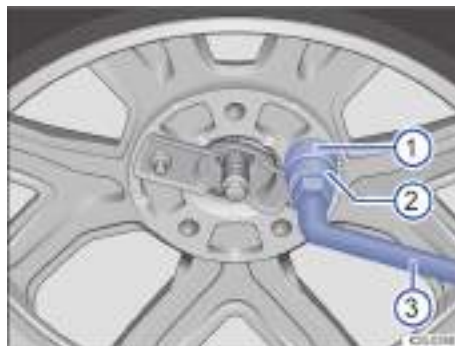
Fig. 197 Retirar la protección antirrobo.
