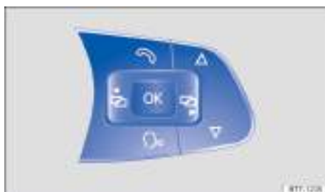
Fig. 12 En el volante multifunción: teclas para utilizar los menús del cuadro de instrumentos.
