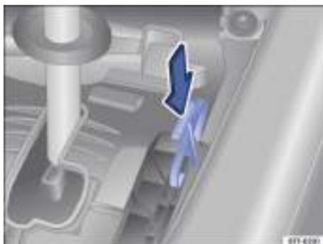
Fig. 97 Desbloqueo de emergencia de la palanca selectora.
